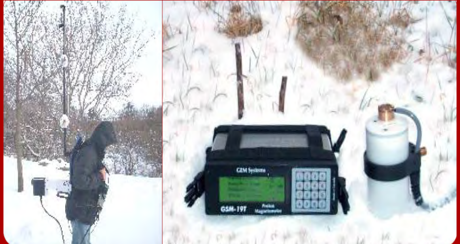
La consola del Magnetómetro de Protones GSM-19T viene con mochila y un Sensor adicional para las lecturas (simultáneas) del gradiómetro, sistema de GPS incorporado y sistema VLF EM
